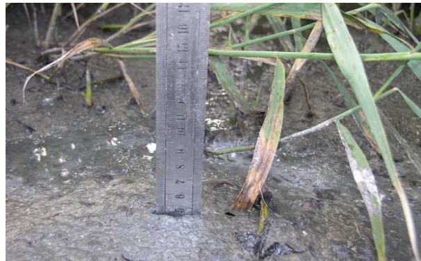
Mesure de la hauteur des boues accumulées sur le 1 er étage
